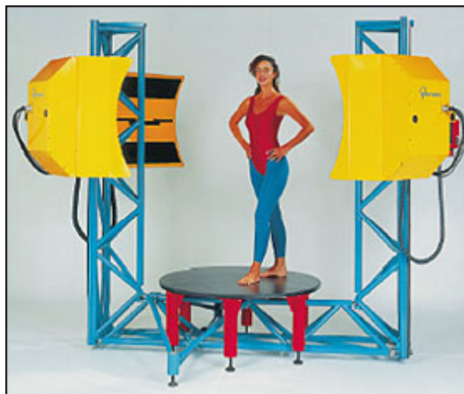
Figura 3 – Modelo real sendo submetido ao processo de scaneamento 3D.
