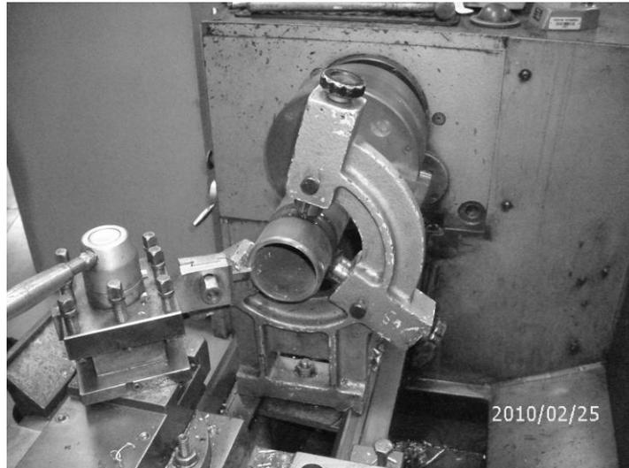
Figura 69: Luneta do Curso Técnico Eletromecânica
