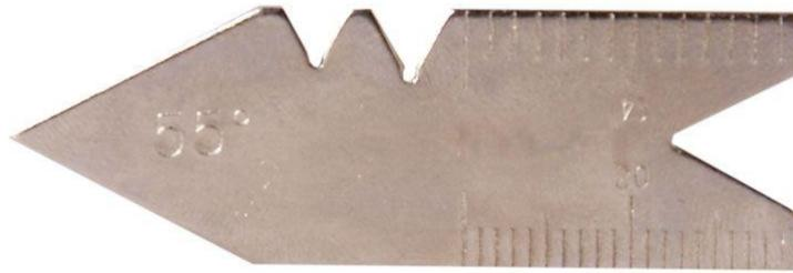
Figura 86: Escantilhão de 55° para rosca triangular whitworth.
