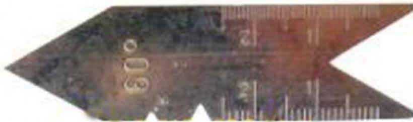
Figura 87: Escantilhão de 60° para roscas triangulares métrica e unificada.
