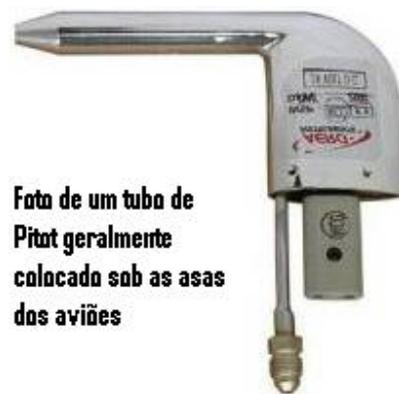
Foto de um tubo de Pitot geralmente colocada sob as asas dos aviões
